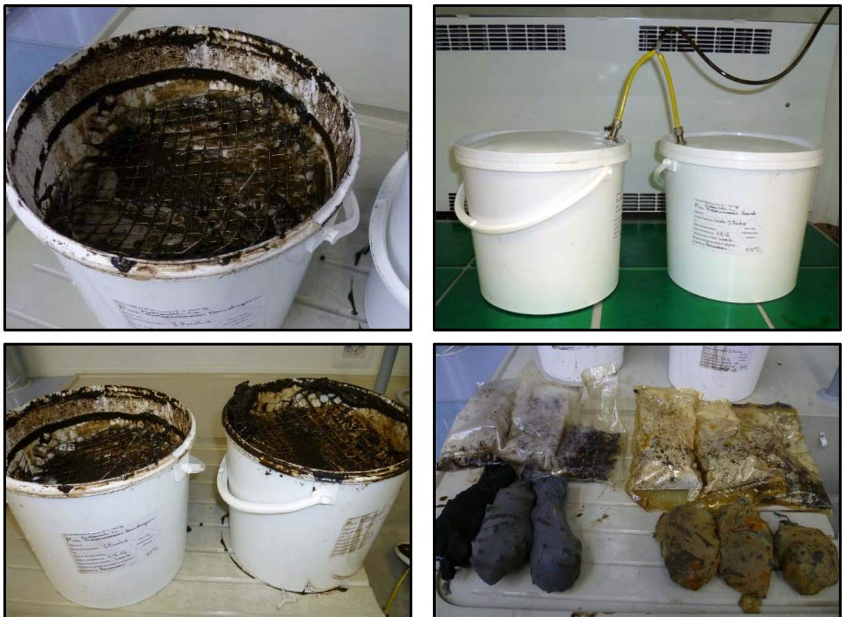
Fig. 5. Test d'exposition dans un réacteur de laboratoire en conditions anaérobies En haut à gauche eau de pressage. En haut à droite: réacteurs en plastique dans l'agitateur avec tuyau de dégazage En bas à gauche: eau de pressage En bas à droite: sachets avec le matériel végétal après leur exposition
