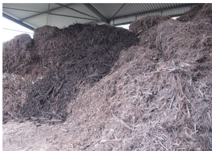
Siebüberlauf unter Dach: der von Plastik befreite Siebüberlauf ist für die thermische Nutzung besser geeignet, wenn er möglichst trocken geliefert wird.
