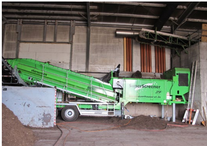
Superscreener: immer mehr Betriebe suchen mit technischen Geräten wie dem Sternsieb «Superscreener» dem Problem Fremdstoffe in den Produkten Herr zu werden.
