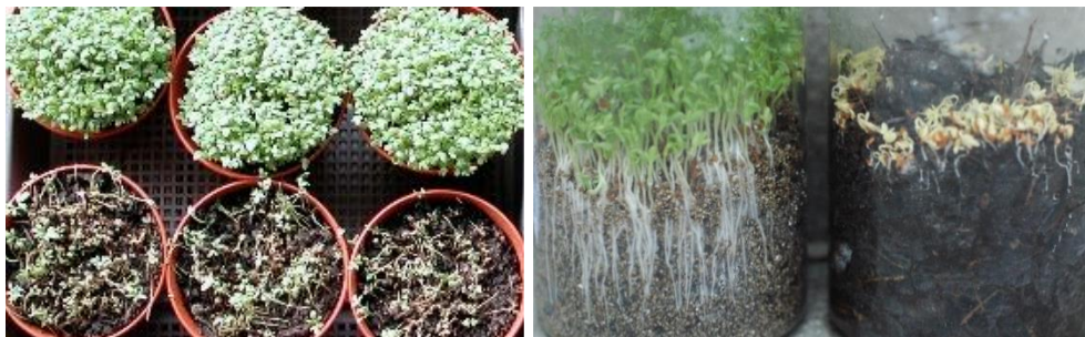
A gauche : Test du cresson ouvert. Le cresson peu développé dans les pots de la rangée inférieure indique un compost à effet phytotoxique. A droite : Test de cresson fermé. Le compost à droite a un effet phytotoxique. (Photos: Jacques Fuchs, FiBL, Frick)
