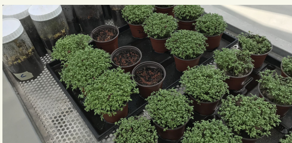
Obr. 1: Uzavretý a otvorený test so žeruchou, 7 dní po sejbe, pripravený k vyhodnoteniu.
