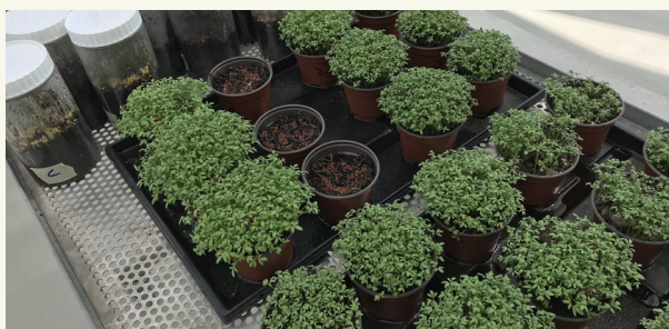
Imagine 1: Testele cu cress deschis și închis, 7 zile după semănat, gata pentru evaluare.
