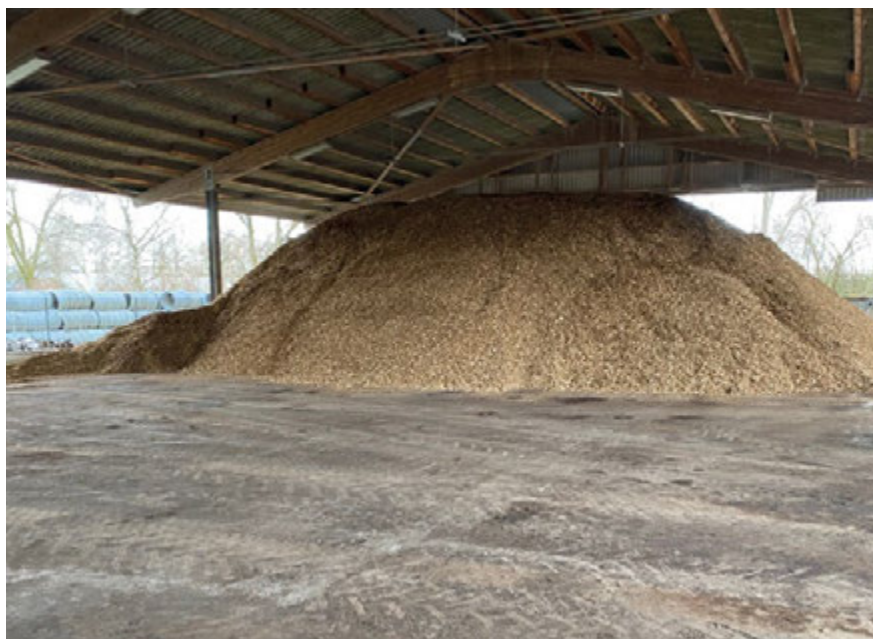
Foto 5: Wenn einmal eine schöne Qualität Holzschnitzel erreicht ist, nimmt die Qualität unter Dach weiter zu, während sie in der Nässe schnell abnimmt.
