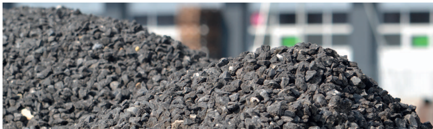
Wird Ausbausphalt qualitätsgeprüft aufbereitet, entsteht der Recyclingbaustoff Asphaltgranulat.
