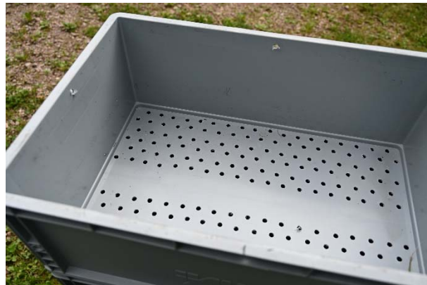
Fig. 2. Vue du fond des bacs percés de nombreux trous de 8,5 mm de diamètre, et des trous d'aération placés sur le haut des côtés des bacs
