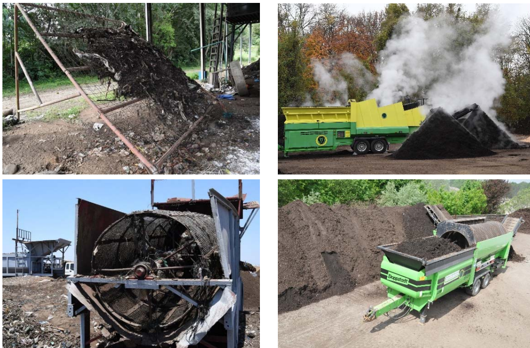
Exemples de cribleuses : tamis artisanaux (en haut à gauche), tamis à étoiles (en haut à droite) et tamis à tambour rotatif (en bas).
