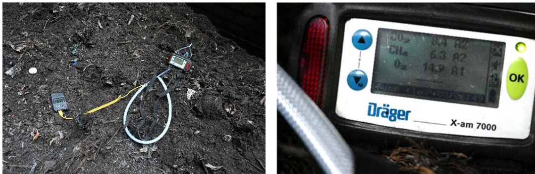
Mesure de la composition des gaz dans un andain.
