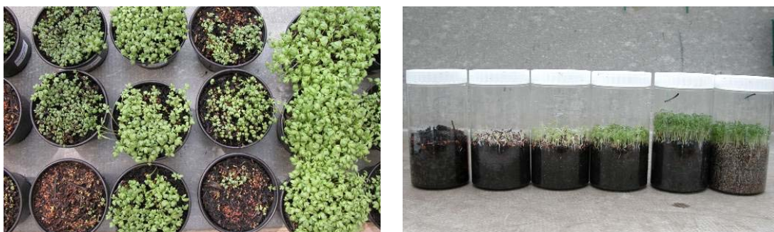
Tests de phytotoxicité pour évaluer la compatibilité des composts avec les plantes. À gauche : test de cresson ouvert. À droite : test de cresson fermé.
