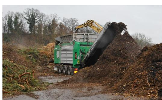
*Beispiele für Schredder für eine Kompostieranlage.*
