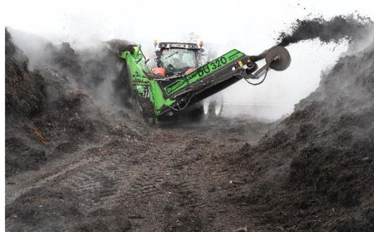
*Beispiel für eine traktorgezogene und selbstfahrende Rührmaschine*
