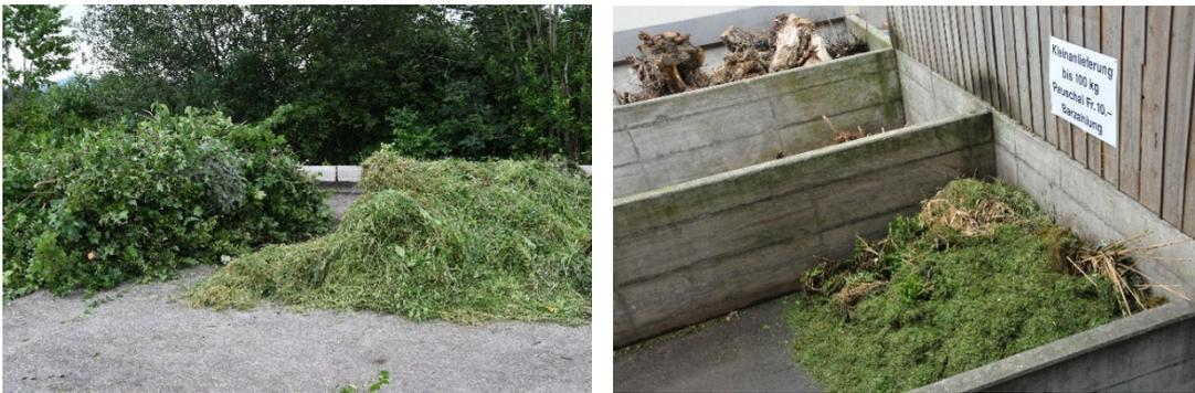
*Beispiele für die Zwischenlagerung von Inputs: in Stapeln (l.), in Boxen (r.).*
