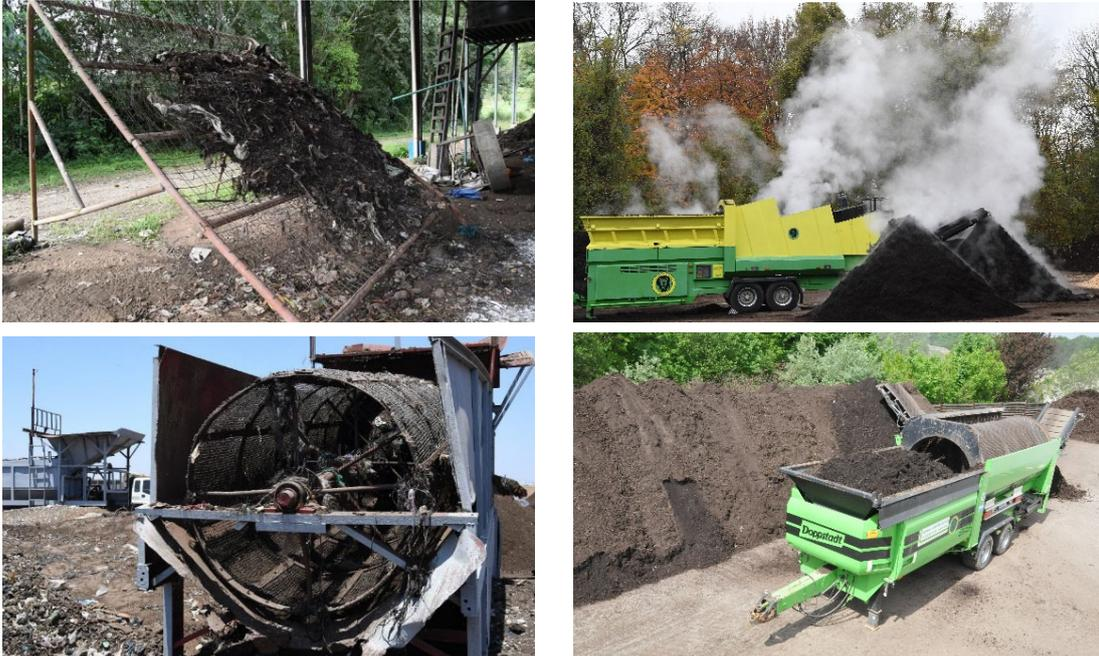
*Beispiele für Siebmaschinen: Handwerksziebe (oben links), Sternsiebe (oben rechts) und Drehtrommelsiebe (unten).*
