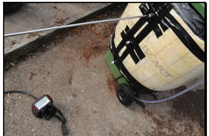
Messung der Gaszusammensetzung (in verschiedenen Höhen des Komposters)
