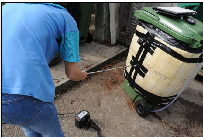
Messung der Gaszusammensetzung (in verschiedenen Höhen des Komposters)
