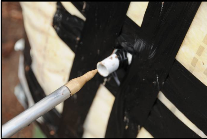
Temperaturmessung (in verschiedenen Höhen des Komposters)
