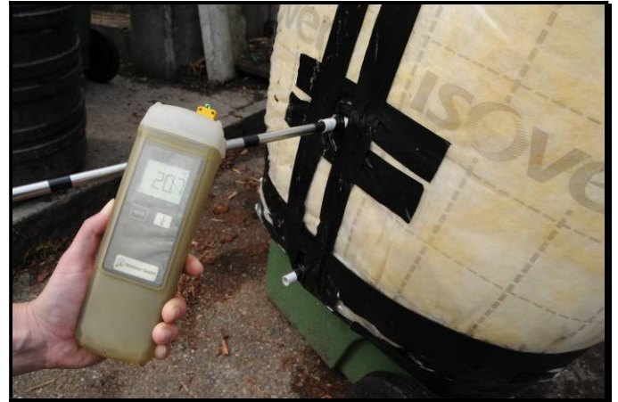
Temperaturmessung (in verschiedenen Höhen des Komposters)
