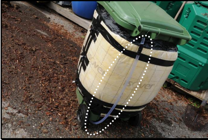
Testkomposter: Ansicht des flexiblen Rohrs zum Ableiten von Sickerwasser 240 Liter
