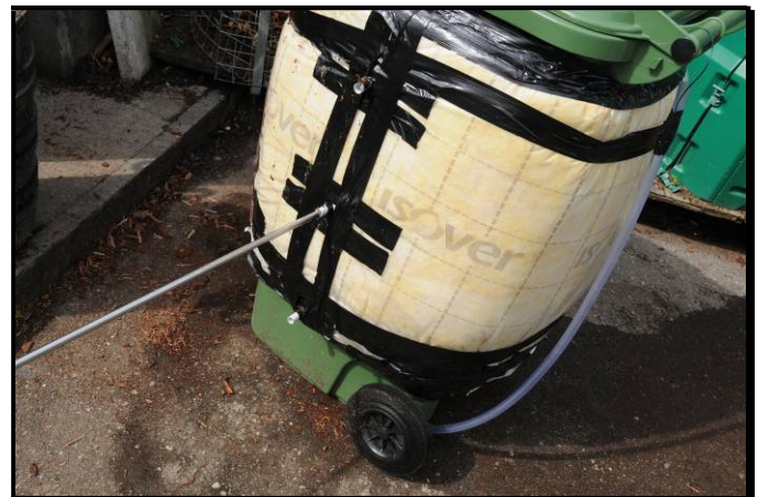
Messung der Temperatur (in verschiedenen Höhen des Komposters)
