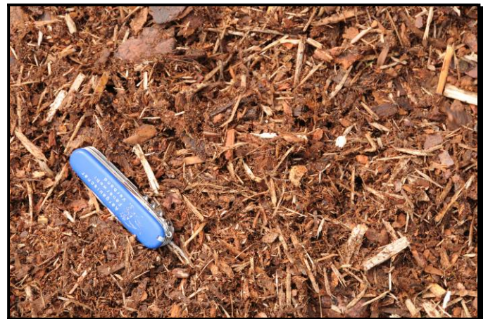
Vorbereitung der zu testenden Mischung: Holzmaterial nach dem Schreddern
