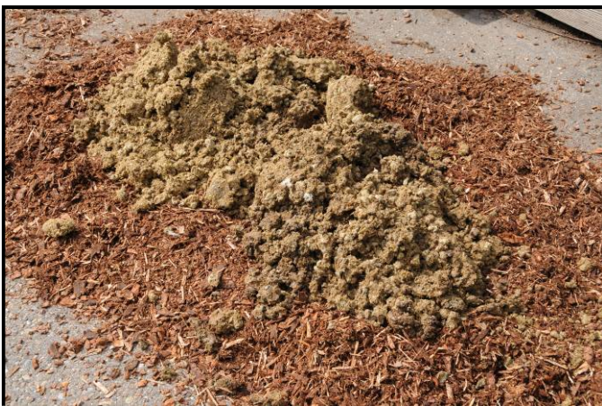
Vorbereitung der zu testenden Mischung: Hinzufügen von anderem Material (z. B. Hühnermist)
