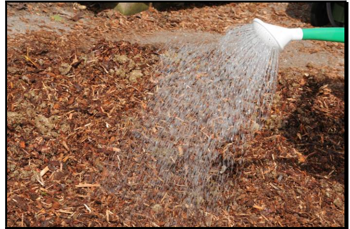
Vorbereitung der zu testenden Mischung: Wasser zur Mischung hinzufügen, bis die optimale Feuchtigkeit erreicht ist
