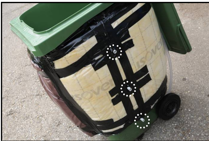
Testkomposter: Ansicht der Löcher für Temperatur- und Gasmessungen
