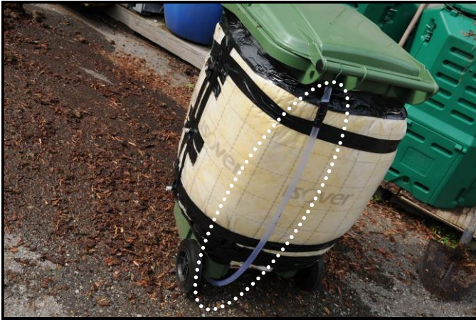
Composteur d'essai : vue du tuyau flexible pour l'évacuation des jus de lixiviation 240 litres
