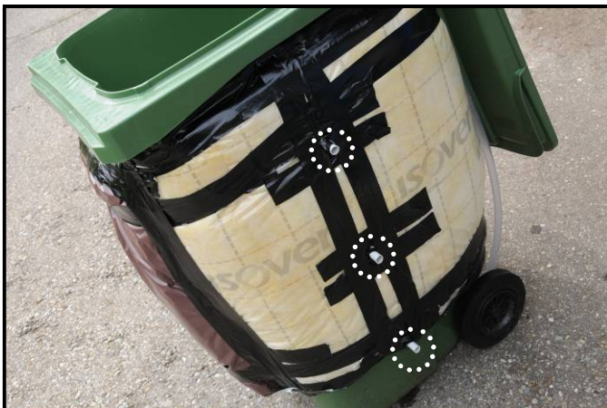
Composteur test : vue des trous pour les mesures de température et de gaz
