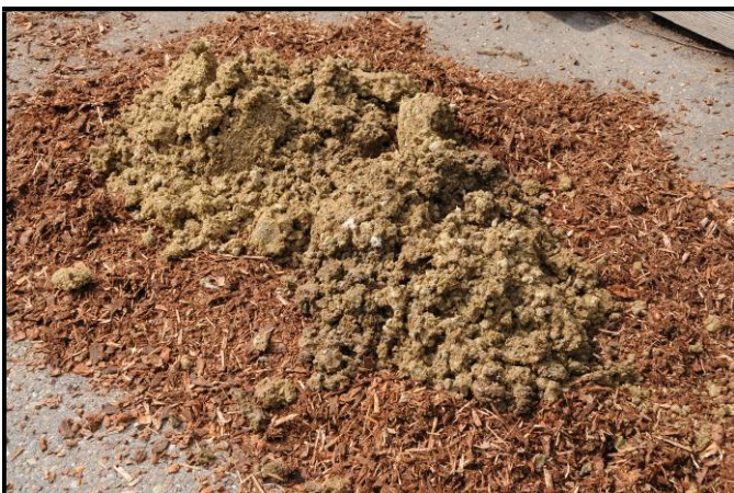
Préparation du mélange à tester : ajouter d'autres matières (par exemple, du fumier de poules)
